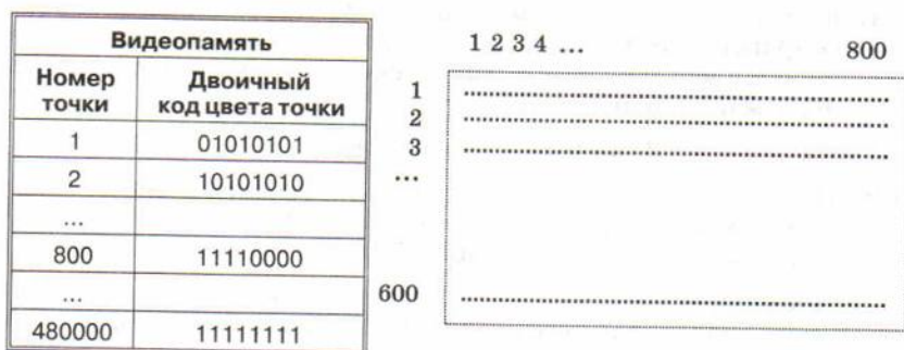
Рис. 1.3. Формирование растрового изображения на экране монитора
