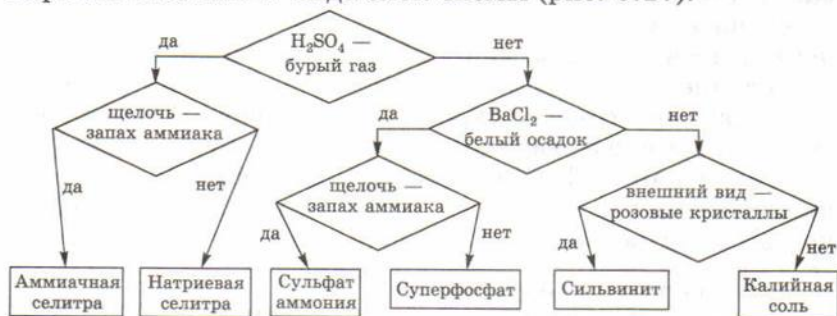
Рис. 5.17. Блок-схема экспертной системы «Распознавание удобрений»
