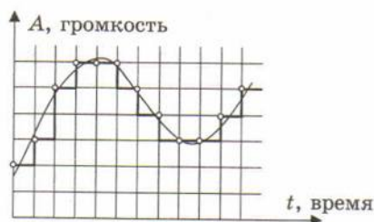
Рис. 1.24. Временная дискретизация звука
